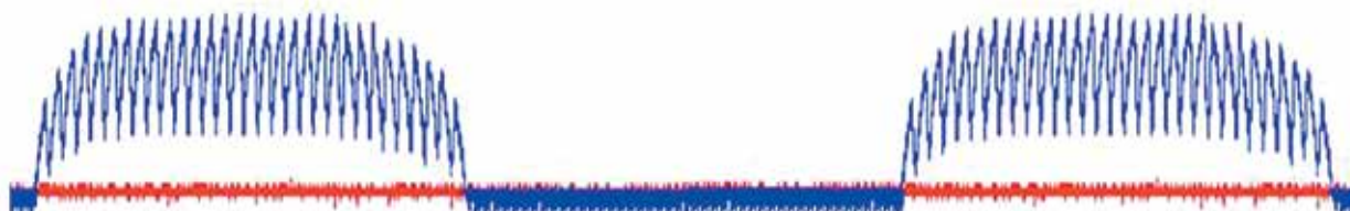
Рис. 4. Графическое изображение серии пневмоимпульсов, генерируемых аппаратом МКВ-01 «Ивавита», длительностью 3 с (пауза — 3 с), с частотой пульсации 10 Гц
